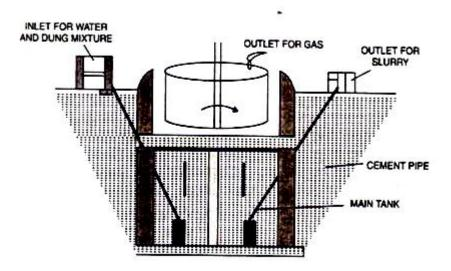
FIG. 4.4 : PLOATING GAS HOLDER TYPE BIOGAS PLANT
