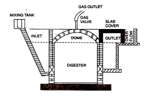
FIQ. 4.3 : FIXED DOME TYPE BIOGAS PLANT
